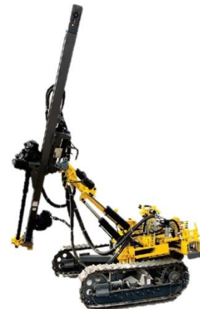
Imagen 24. DM4 Crawler Drill
