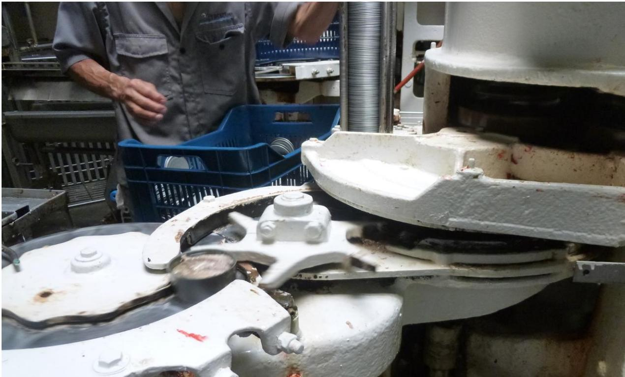
Falta de mantenimiento en máquina cerradora de envases de conserva de pescado.
