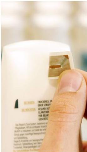
Utilización de tarjetas RFID (Radio frecuencia identificación) son dispositivos pequeños, similares a una pegatina que pueden ser adheridas o incorporadas a un producto el cual contiene antenas que permite recibir y responder a peticiones por radiofrecuencia
