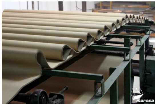
Maquina de corrugado
