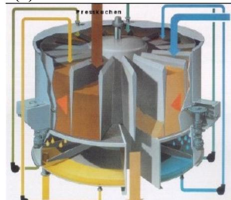
Figura 10.2: Equipo para la extracción con solventes<sup>18</sup>
