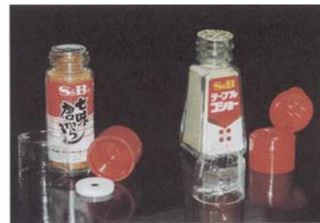
Fig. 25 Envases para productos en polvo, con manga contractil, dosificador y tapa totalmente plásticas y diafragma termosellado, que permiten detectar violación de la integridad del envase
